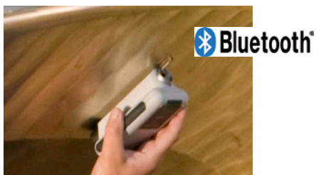
Mesure d'une hélice marine avec unité de palpation MarSurf RD 18 et palpeur PHT 6-350 en liaison sans fil
